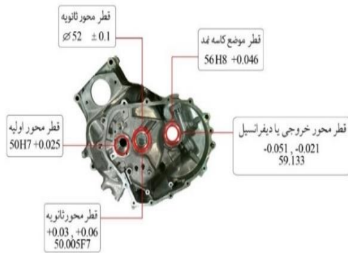
شکل (۴) مواضع قطعه پوسته کلاچ
